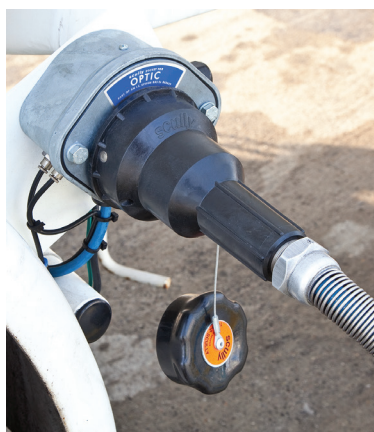
Одно соединение для заземления и предотвращения переполнения
